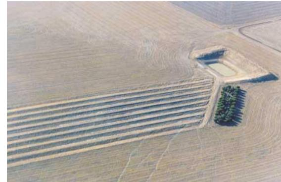
Finca agropecuaria diseñado para colecta, conducción y almacenamiento aguas de lluvia
